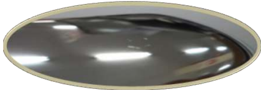
Gambar 4.34 jenis cacat hike (Sumber: PT Surya Toto Indonesia, Tbk)
