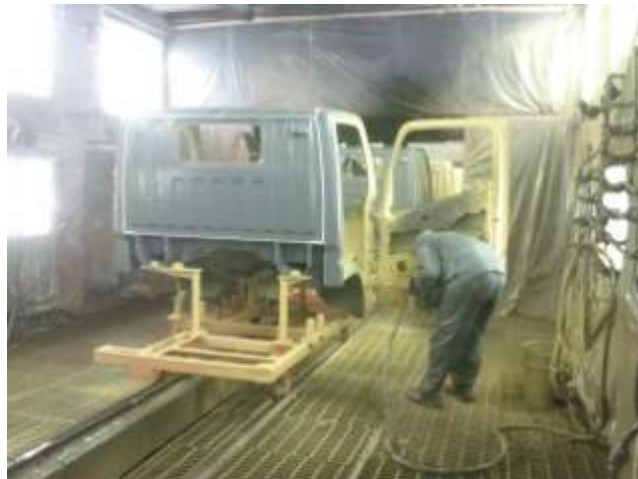
Gambar 4.9. Proses Touch up dengan Manual Spray (Sumber : Pengumpulan Data)
