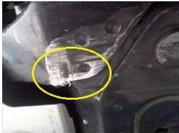
Gambar 4.16. Jenis cacat retak (Sumber : Pengumpulan Data)
