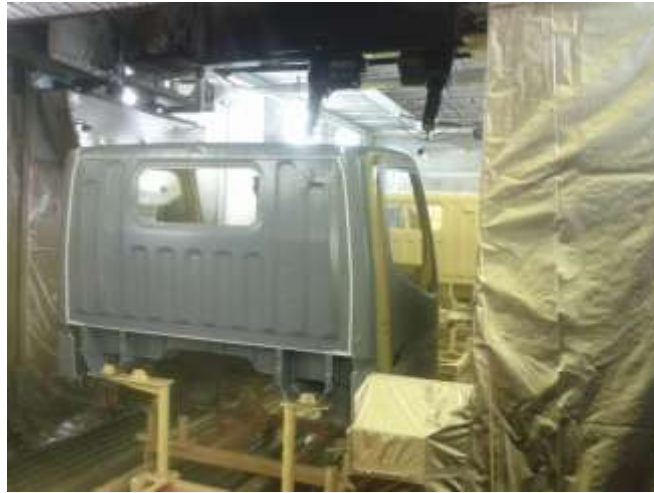
Gambar 4.10. Proses touch up dengan Automatic Spray Machine (Sumber : Pengumpulan Data)
