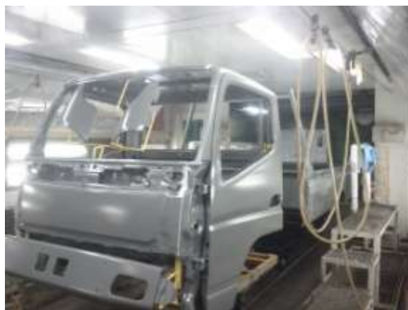
Gambar 4.8. Proses Sealing dan Under Coat (Sumber : Pengumpulan Data)
