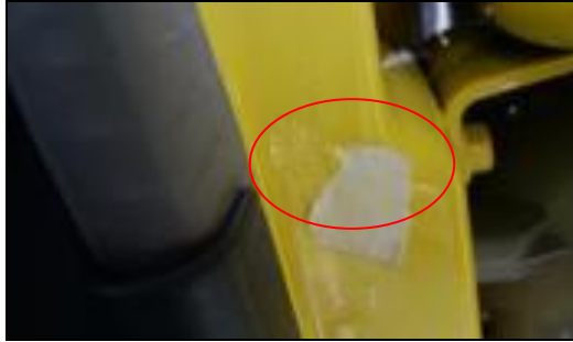
Gambar 4.14. Jenis cacat Dirty (butsu) (Sumber : PT Krama Yudha Ratu Motor)
