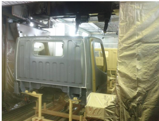
Gambar 4.9. Proses Top Coat dengan Automatic Spray Machine (Sumber : PT Krama Yudha Ratu Motor)
