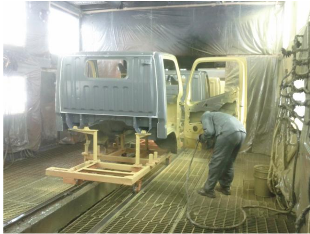
Gambar 4.8. Proses Top Coat dengan Manual Spray (Sumber : PT Krama Yudha Ratu Motor)
