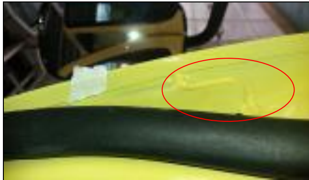
Gambar 4.16. Jenis cacat Thin (Sumber : PT Krama Yudha Ratu Motor)
