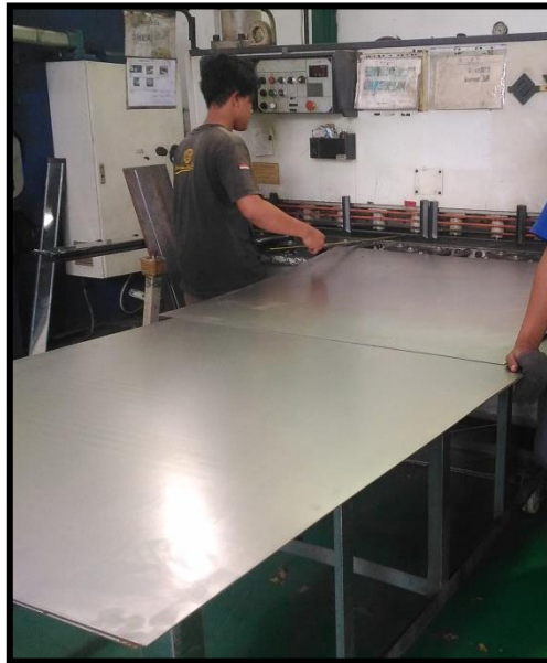
Gambar IV.23 Plat Stainless Yang Akan Dipotong Sumber: PT Laksana Teknik Makmur (2016)
