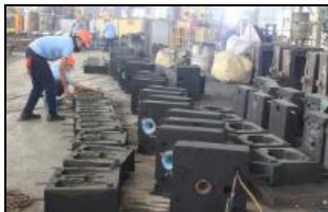
Gambar IV.10 Bahan Pembungkus ( Mold Casting ) (Sumber: PT Alcorindo Sejahtera, 2015)
