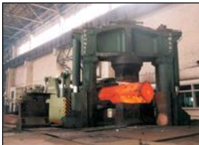
Gambar IV.13 Proses Forging (Sumber: PT Alcorindo Sejahtera, 2015)
