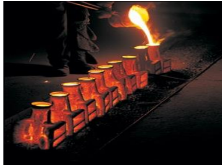
Gambar IV.12 Pengecoran (Sumber: PT Alcorindo Sejahtera, 2015)
