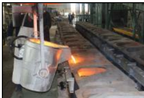
Gambar IV.11 Penuangan Logam Cair ke Dalam Bahan Pembungkus ( Mold Casting ) (Sumber: PT Alcorindo Sejahtera, 2015)
