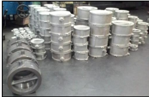
Gambar IV.9 Bahan Baku Casting Check Valve yang Diterima dari Supplier (Sumber: PT Samudera Berlian Metalindo, 2015)
