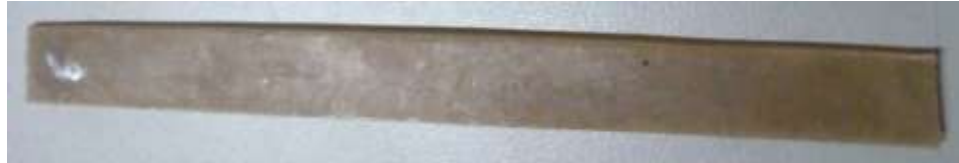
Gambar 3.7 Bentuk Spesimen Pengujian kekuatan Bending
