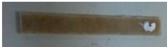
Gambar 3.9 Bentuk Spesimen Pengujian Kekuatan Impak
