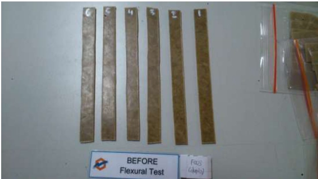
Gambar D.12 Spesimen Pengujian Kekuatan Bending Sebelum Dilakukan Pengujian
