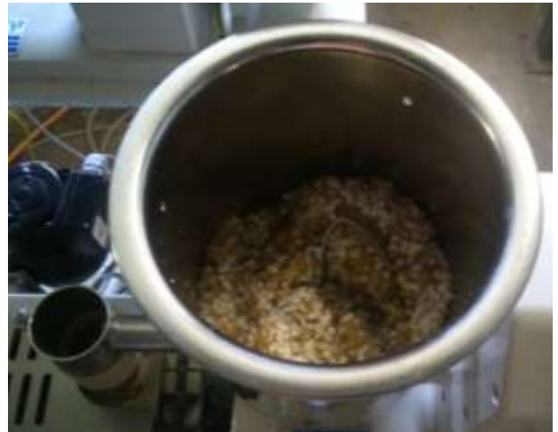
Gambar D.3 Proses Ekstrusi Serat Kenaf & HDPE
