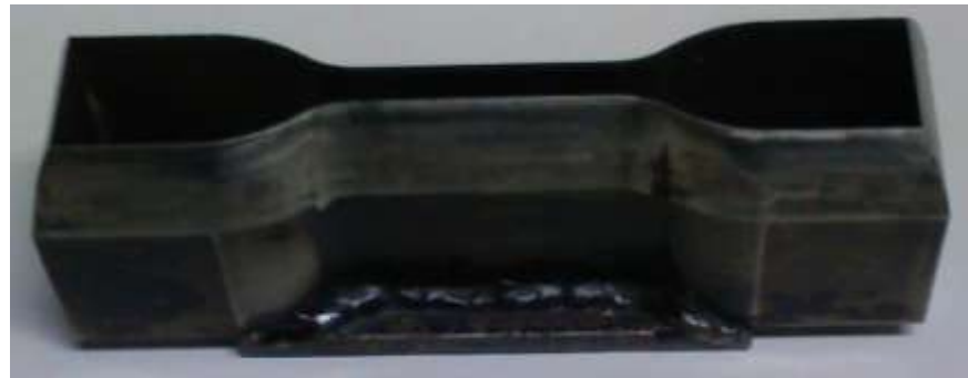
Gambar 3.6 Cetakan Spesimen Pengujian Kekuatan Tarik
