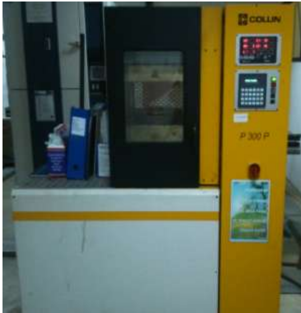
Gambar A.4 Mesin Hot Press (kiri) dan climatic chamber (kanan)
