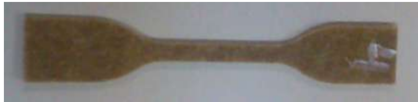
Gambar 3.5 Bentuk Spesimen Pengujian Kekuatan Tarik
