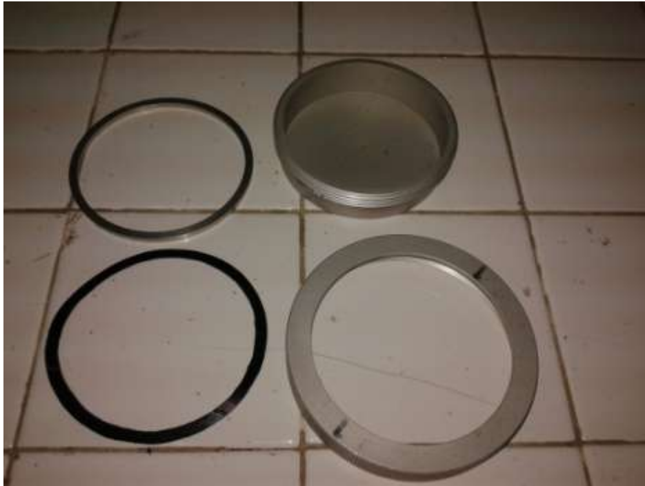
Gambar 19. Cawan dan ring untuk pengujian WVTR
