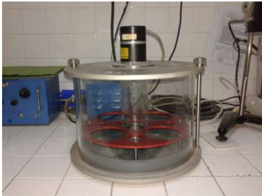
Gambar 16. Chamber untuk uji WVTR
