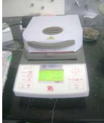
(b) Moisture analyzers Ohaus MB-45 untuk analisa kadar air
