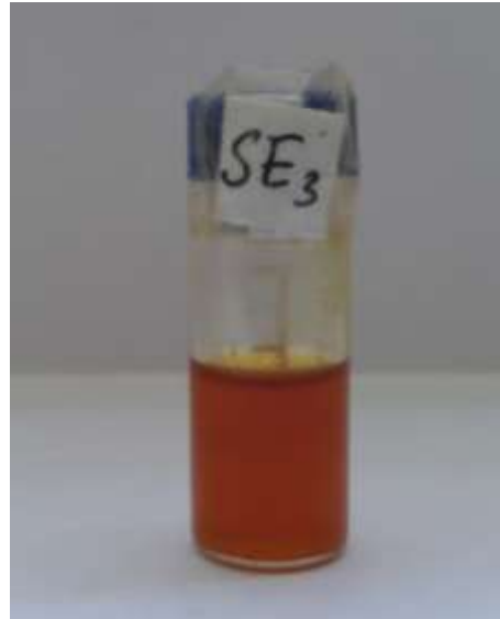
(d) Minyak Jahe Emprit Hasil Ekstraksi menggunakan Fluida CO 2 Superkritik dengan Tekanan 4500 psi
