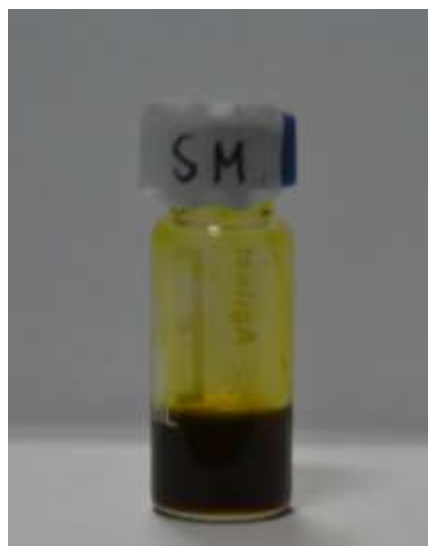
(b) Minyak Jahe Merah Hasil Ekstraksi menggunakan Fluida CO 2 Superkritik dengan Tekanan 4000 psi
