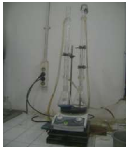
(d) Alat pendingin tegak untuk analisa karbohidrat
