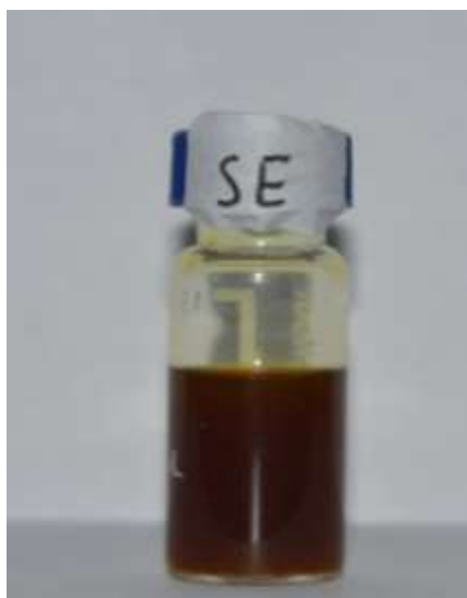
(a) Minyak Jahe Emprit Hasil Ekstraksi menggunakan Fluida CO 2 Superkritik dengan Tekanan 4000 psi
