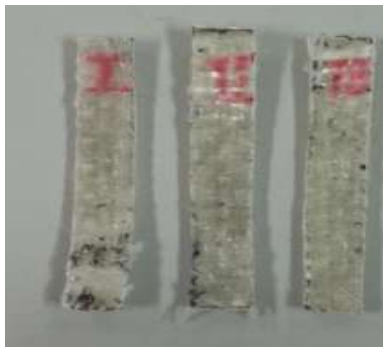
Gambar IV.11 Sampel Uji Flexural Komposit Glass Fiber dan Unsaturated Polyester Resin Sebelum dan Sesudah Pengujian
