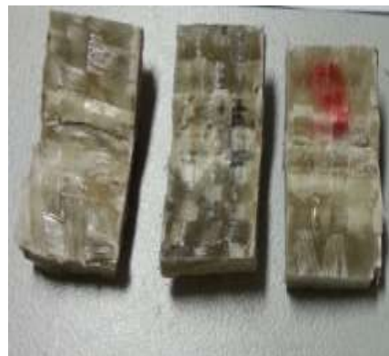
Gambar IV.8 Sampel Uji Shear Komposit Glass Fiber dan Unsaturated Polyester Resin Sebelum dan Sesudah Pengujian
