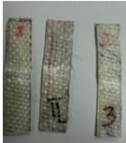
Gambar IV.4 Sampel Uji Compressive Komposit Glass Fiber dan Epoxy Resin Sebelum dan
