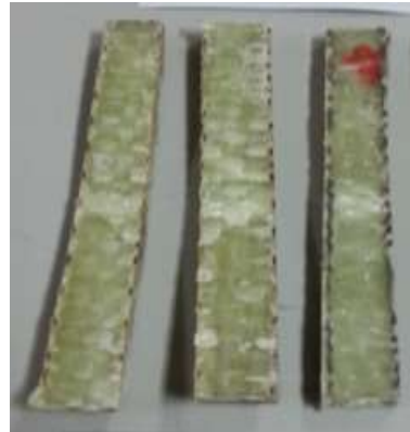
Gambar IV.10 Sampel Uji Flexural Komposit Glass Fiber dan Epoxy Resin Sebelum dan Sesudah Pengujian
