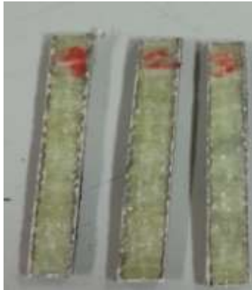
Gambar IV.10 Sampel Uji Flexural Komposit Glass Fiber dan Epoxy Resin Sebelum dan Sesudah Pengujian
