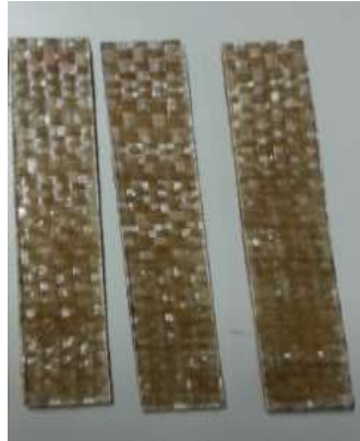
Compressive Komposit Glass Fiber dan Vinyl Ester Resin Sebelum dan Sesudah Pengujian
