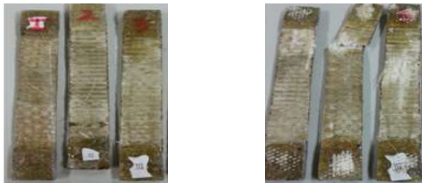
Gambar IV.2 Sampel Uji Tensile Komposit Glass Fiber dan Unsaturated Polyester Resin Sebelum dan Sesudah Pengujian
