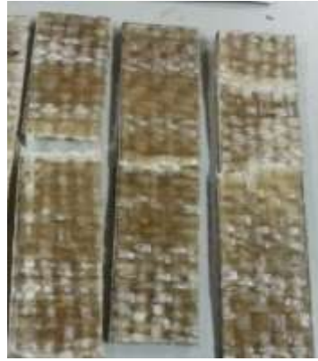
Compressive Komposit Glass Fiber dan Vinyl Ester Resin Sebelum dan Sesudah Pengujian
