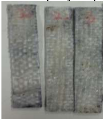
Gambar IV.4 Sampel Uji Compressive Komposit Glass Fiber dan Epoxy Resin Sebelum dan
