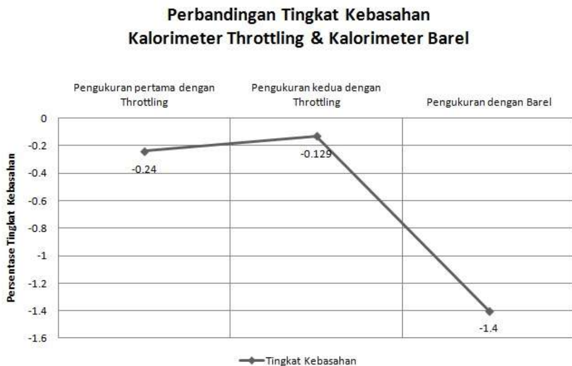
Gambar 4.1 Perbandingan Tingkat Kebasahan Kalorimeter Throttling dan Barel
