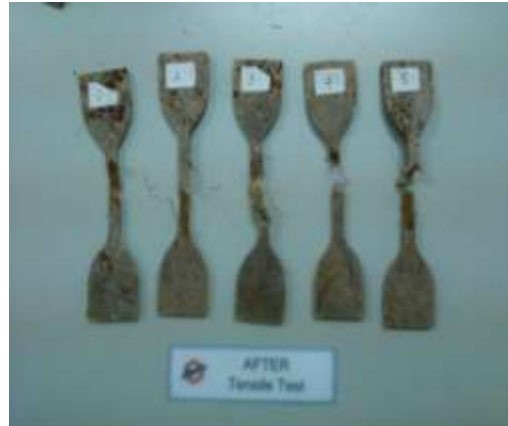
Gambar 3.29 Spesimen Uji komposisi 50 phr serabut kelapa after test (Latex)
