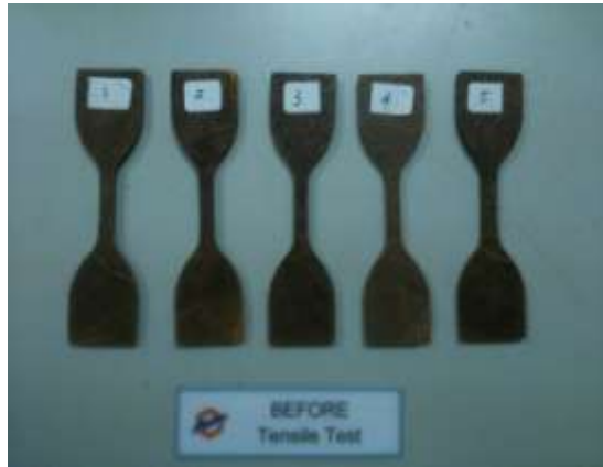
Gambar 3.20 Spesimen Uji komposisi 50 phr serabut kelapa ( Crumb Rubber )
