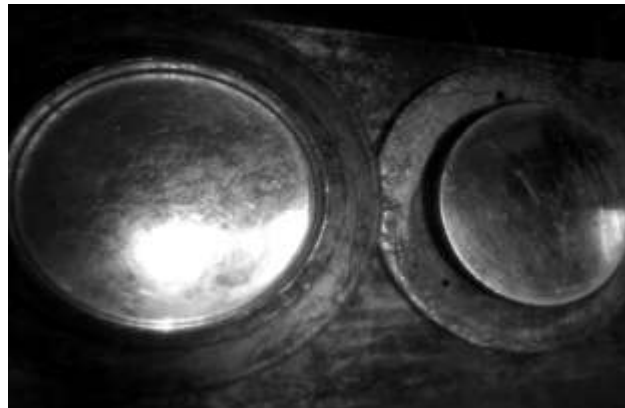
Gambar 3.10 Cetakan Hot Press
