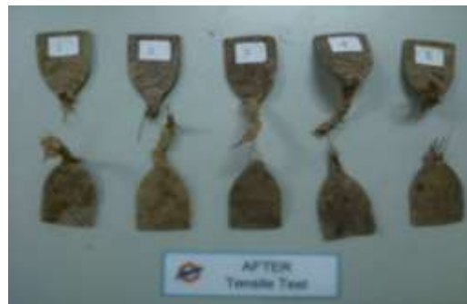
Gambar 3.27 Spesimen Uji komposisi 10 phr serabut kelapa after test (Latex)
