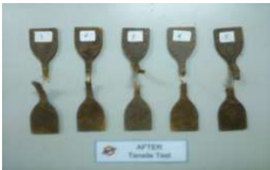
Gambar 3.26 Spesimen Uji komposisi 50 phr serabut kelapa after test (Crumb Rubber)
