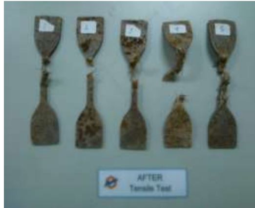
Gambar 3.28 Spesimen Uji komposisi 30 phr serabut kelapa after test (Latex)
