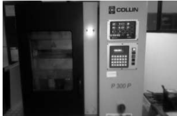
Gambar 3.9 Hot Press Tipe 300 P
