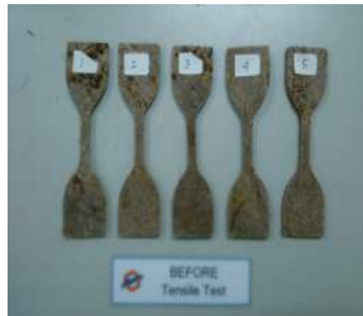
Gambar 3.23 Spesimen Uji komposisi 50 phr serabut kelapa ( Latex )
