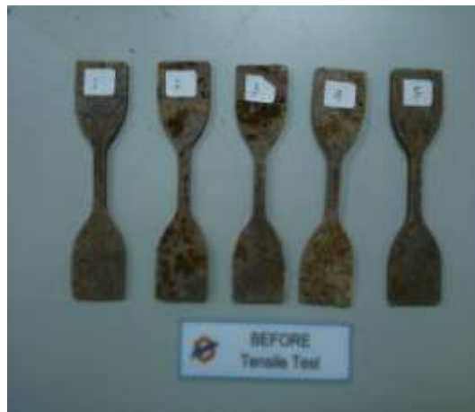
Gambar 3.22 Spesimen Uji komposisi 30 phr serabut kelapa ( Latex )
