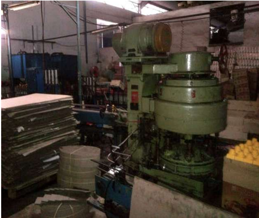
Gambar 4.6 Mesin Produksi Untuk proses pemberian tutup pada botol
