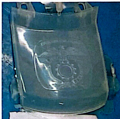
Gambar 2. Produk komposit dengan tekanan sebesar 75 MPa
