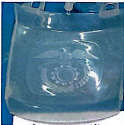
Gambar 1. Produk komposit dengan tekanan sebesar 55 MPa
