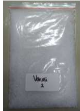
Gambar C.2 Polipropilena 98% dengan Masterbatch White 2%
