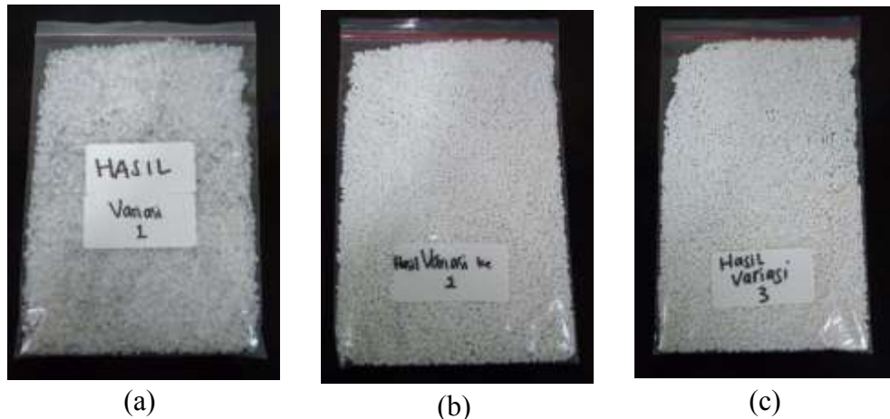
Gambar 4.1 Hasil variasi kompon Polipropilena dengan Masterbatch White 50
