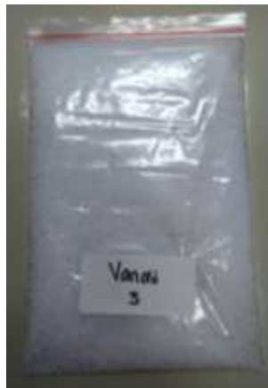
Gambar C.3 Polipropilena 96% dengan Masterbatch White 4%
