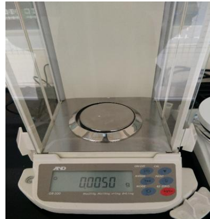
Penimbangan Sampel Untuk Pengujian DSC
