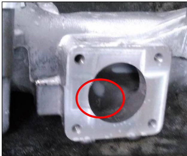
Gambar 4.23 Cacat Shrinkage (Kempot) (Sumber: PT XYZ)
