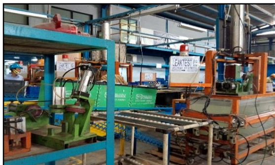
Gambar 4.17 Ruang Proses Uji Kebocoran ( Leak Test ) (Sumber : PT XYZ, 2017)
