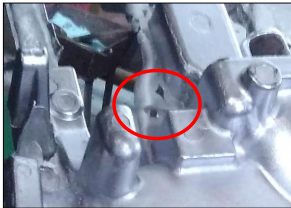
Gambar 4.21 Cacat Keropos (Sumber: PT XYZ, 2017)
