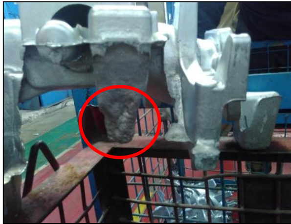
Gambar 4.22 Cacat Misrun (Sumber: PT XYZ, 2017)
