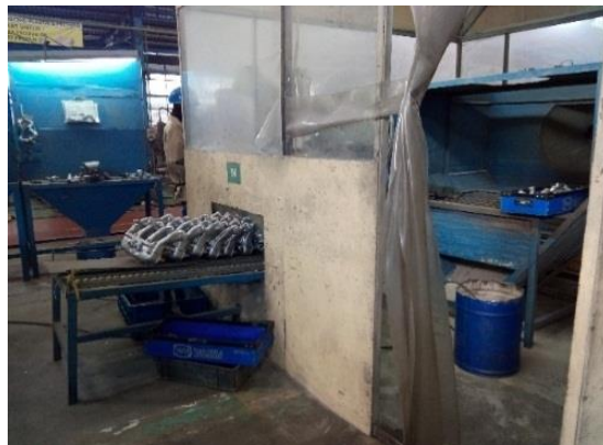
Gambar 4.15 Ruang Sand Blasting (Sumber : PT XYZ, 2017)
