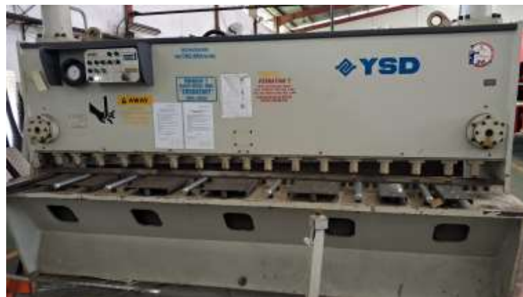
Gambar 5. 5 Mesin potong plat tanpa adanya batas aman (sumber: PT Astanita Sukses Apindo)
