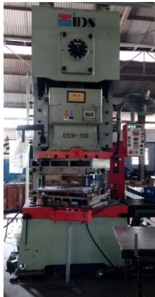
Gambar 4.6 Mesin Press Medium 160 ton (Sumber: PT Nusa Indah Jaya Utama)
