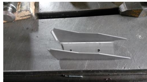
Gambar 4.14 Proses Bending (Sumber: PT Nusa Indah Jaya Utama)
