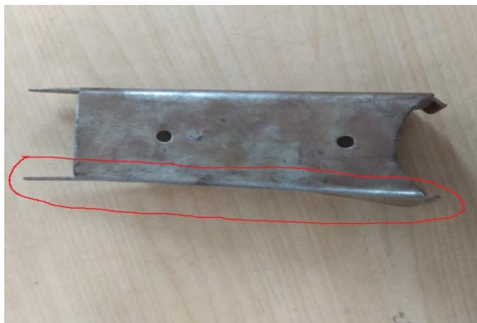
Gambar 4.20 Jenis Cacat Bending Miring (Sumber: PT Nusa Indah Jaya Utama)
