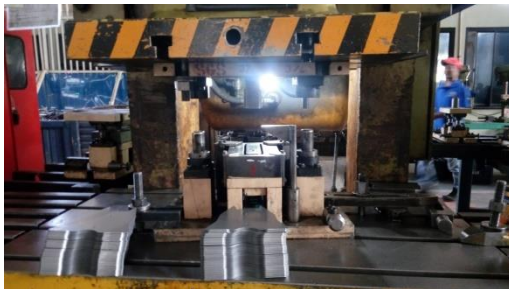
Gambar 4.13 Dies Proses Bending (Sumber: PT Nusa Indah Jaya Utama)
