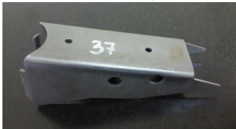
Gambar 4.4 Reinf Pivot Tube Bottom R1120069 (Sumber: PT Nusa Indah Jaya Utama)
