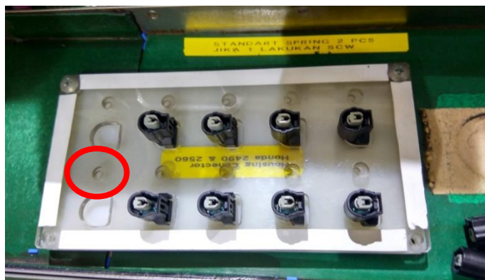
Gambar 5.7 Palet part housing connector dan retainer (Sumber: Divisi produksi PT Denso Indonesia)
