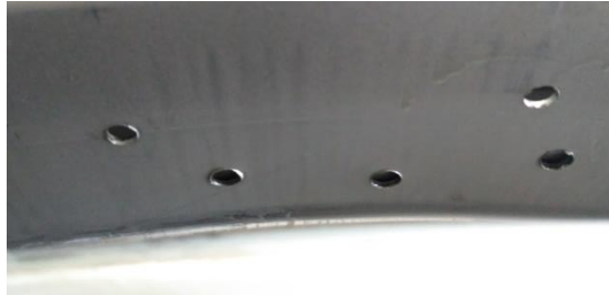
Gambar 4.12. Proses Pelubangan ( Pierc 2 ) (Sumber: PT CSM)
