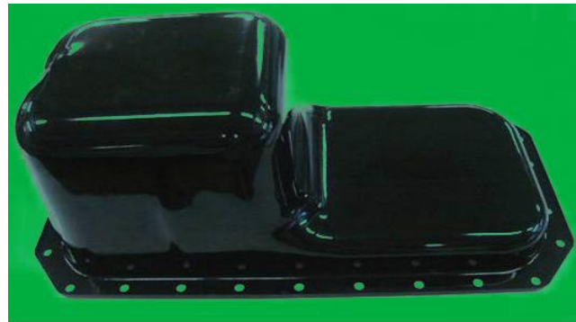
Gambar 4.1. Oil Pan untuk Truck Engine pada PT HINNO (Sumber: PT Cidas Supra Metalindo)
