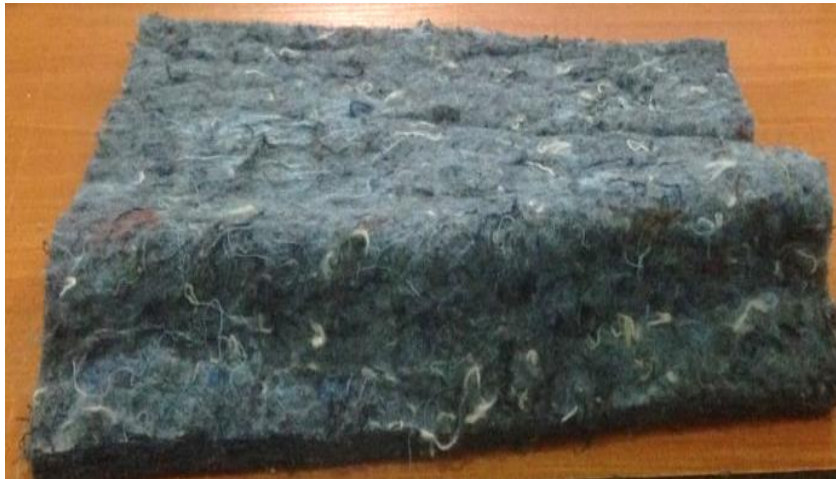
Gambar 4.27. Jenis Cacat Gelombang (Sumber: PT Rekadaya Multi Adiprima)
