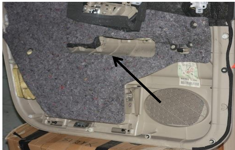
Gambar 4.12. Penempatan Felto Pad FR Door Trim BZ120 pada Pintu Mobil (Sumber: PT Rekadaya Multi Adiprima)
