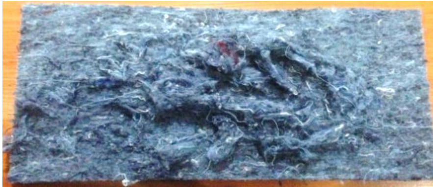
Gambar 4.25. Jenis Cacat Brudul (Sumber: PT Rekadaya Multi Adiprima)
