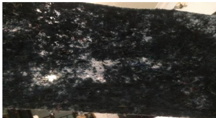
Gambar 4.24. Jenis Cacat Terawang (Sumber: PT Rekadaya Multi Adiprima)
