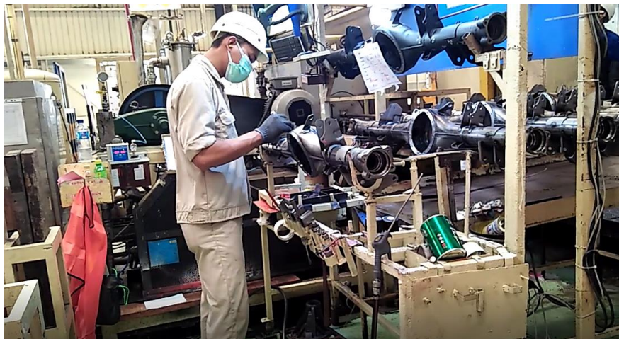
Gambar 4.14 Kegiatan Proses Inspeksi Komponen Housing Assy (Sumber: Pengolahan Data)
