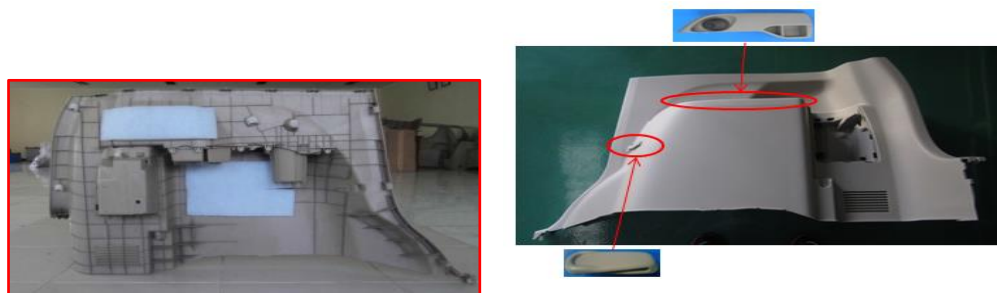
Gambar 4.16 Joint part yang dipasang pada part Trim Comp Quarter Inner Lower RH
