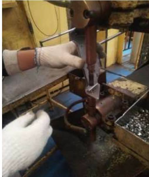
Gambar 4.4. Pemasangan Nut M.8 x 1 pada Main Bracket (Sumber: PT Metindo Easakti)
