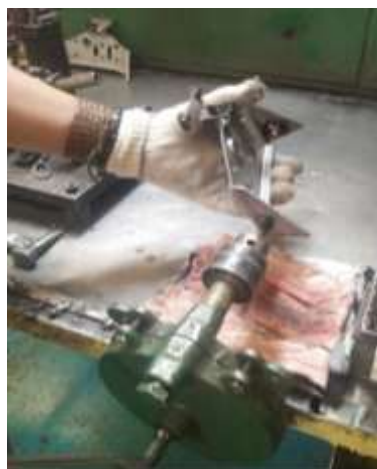
Gambar 4.9. Proses retapping nut M.8 x 1 pada main bracket (Sumber: PT Metindo Easakti)
