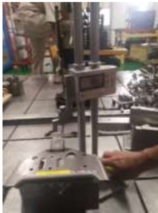
Gambar 4.12. Measuring Inspection menggunakan alat ukur rome cim core (Sumber: PT Metindo Easakti)
