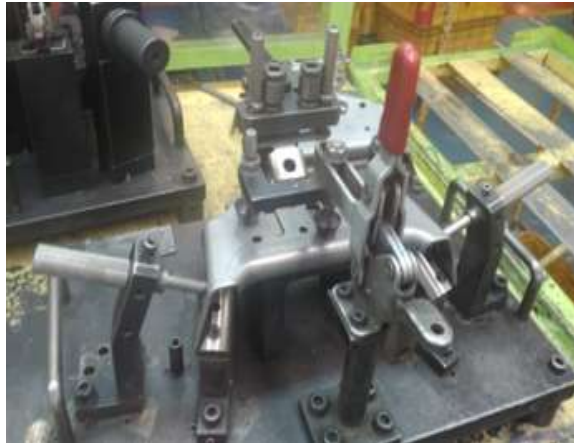
Gambar 4.10. Inspection jig pada produk Bracket Seat (Sumber: PT Metindo Easakti)
