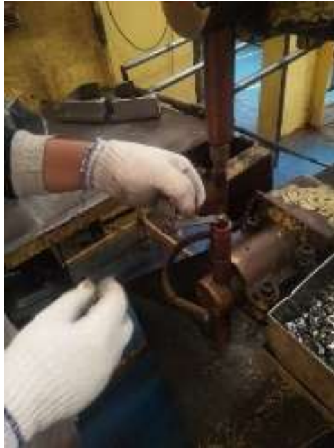
Gambar 4.6. Pemasangan Nut M.6 x 1 pada Bracket Tail Light (Sumber: PT Metindo Easakti)
