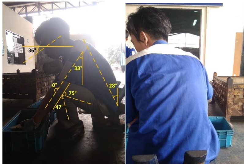
Gambar 4.5 Posisi Kerja Operator pada Fase Gerakan 1 (Lanjutan) (Sumber: Hasil Pengolahan Data)
