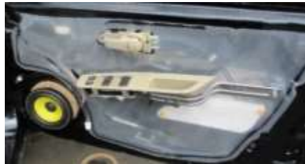
Gambar 4. 12 Penempatan Service Hole pada Pintu Mobil (Sumber: PT Rekadaya Multi Adiprima)
