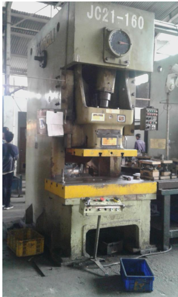
Gambar 4.2 Mesin Press 160 Ton Sumber: (PT Nusa Indah Jaya Utama)
