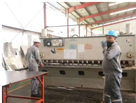
Gambar 4. 5 Proses Pemotongan Plat (Sumber: PT Astanita Sukses Apindo)
