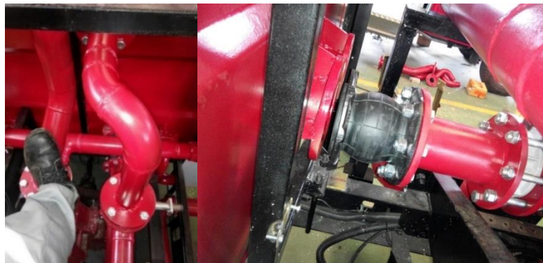
Gambar 4. 15 Cacat Ketidaksesuaian Flange (Sumber: PT Astanita Sukses Apindo)
