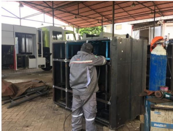
Gambar 4. 8 Proses Pemasangan Siku (Sumber: PT Astanita Sukses Apindo)
