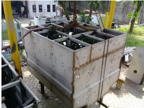
Gambar 4. 11 Proses Pengetesan Tangki Air (Sumber: PT Astanita Sukses Apindo)
