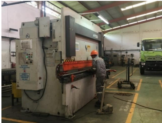
Gambar 4. 6 Proses Bending Plat (Sumber: PT Astanita Sukses Apindo)
