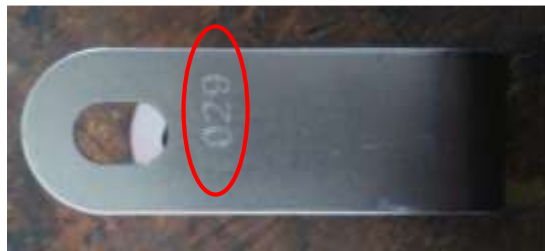
Gambar 4. 23 Jenis Cacat Marking Miring (Sumber: PT Hadeka Primantara)
