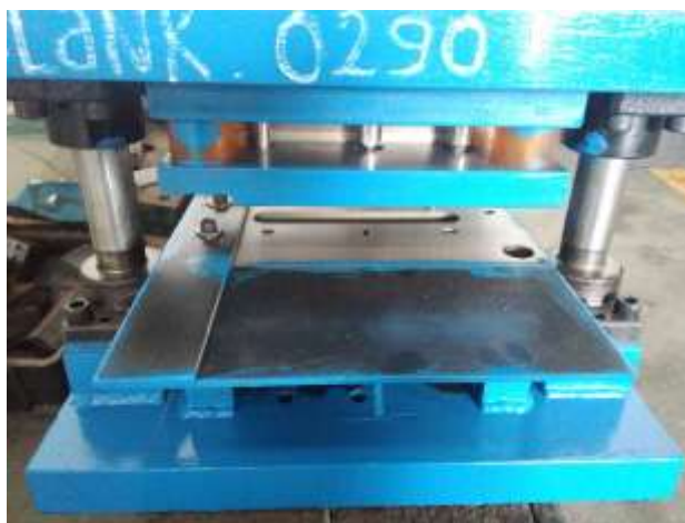
Gambar 5. 5 Dies Blank-Piercing setelah improvement (Sumber: PT Hadeka Primantara)
