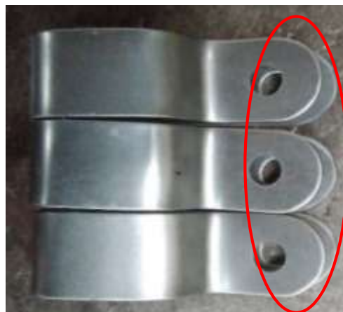
Gambar 4. 24 Jenis Cacat Bending Geser (Sumber: PT Hadeka Primantara)
