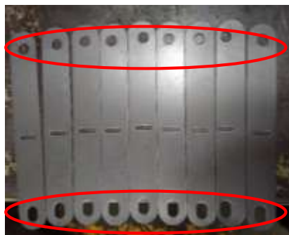
Gambar 4. 20 Jenis Cacat Hole Tidak Center (Sumber: PT Hadeka Primantara)
