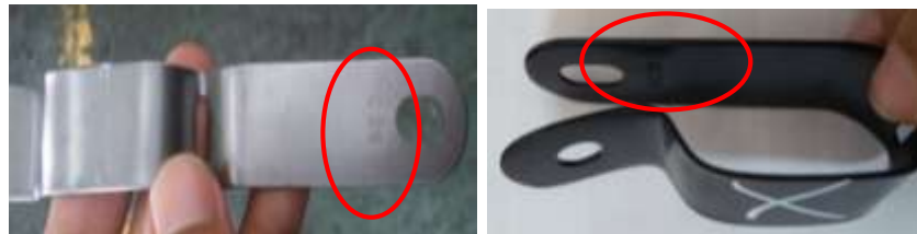
Gambar 4. 26 Jenis Cacat Salah Bending (Sumber: PT Hadeka Primantara)
