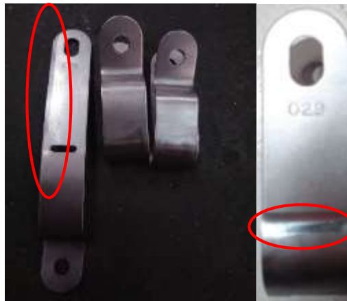
Gambar 4. 25 Jenis Cacat Penyok (Sumber: PT Hadeka Primantara)
