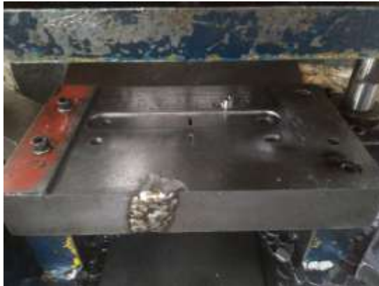
Gambar 5. 4 Dies Blank-Piercing sebelum improvement (Sumber: PT Hadeka Primantara)
