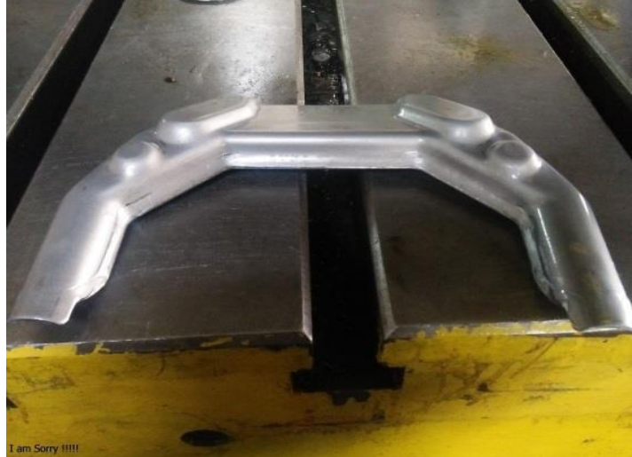
Gambar 4.7. Proses Flange (Sumber: PT Nusa Indah Jaya Utama)
