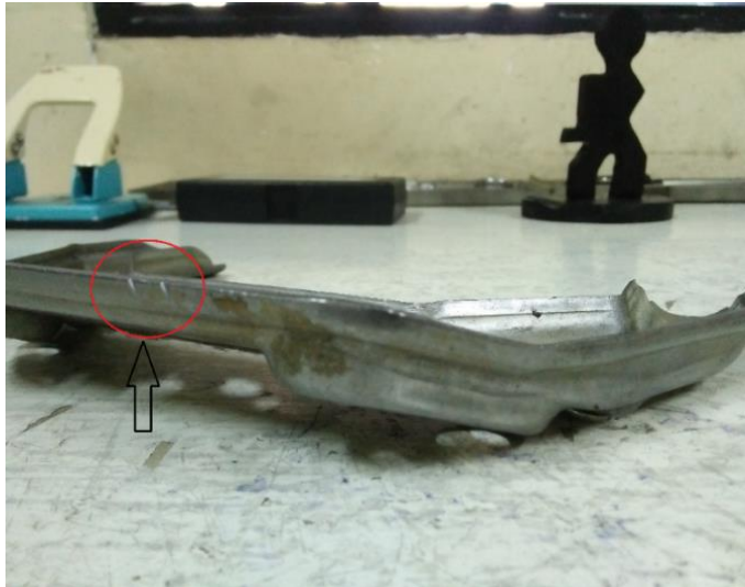
Gambar 4.12. Jenis Cacat Crack (Sumber: PT Nusa Indah Jaya Utama)
