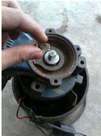
Gambar 5.4 seal setelah perbaikan (Sumber: PT Tirta Sumber Makmur)
