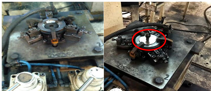
Gambar 5.13 Penggunaan Datum Pin Jig OP-20 Sebelum dan Sesudah Perbaikan (Sumber: PT GKD)
