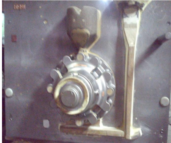
Gambar 5.5 Area takikan dibuat menjadi lebih landai (Sumber : PT Bakrie Autoparts)
