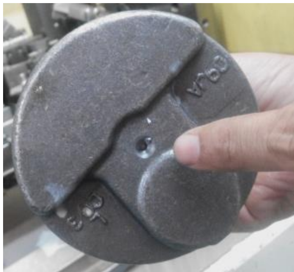
Gambar 4.7 Titik Nol Pada Crankshaft ( Output dari OP10)
