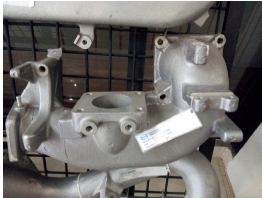
Gambar 4.3. Pipe Intake (Sumber : PT XYZ, 2017)
