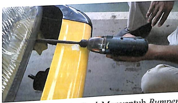
Gambar 5.2 Joint Sock Menyentuh Bumper (Sumber: PT KRM)
