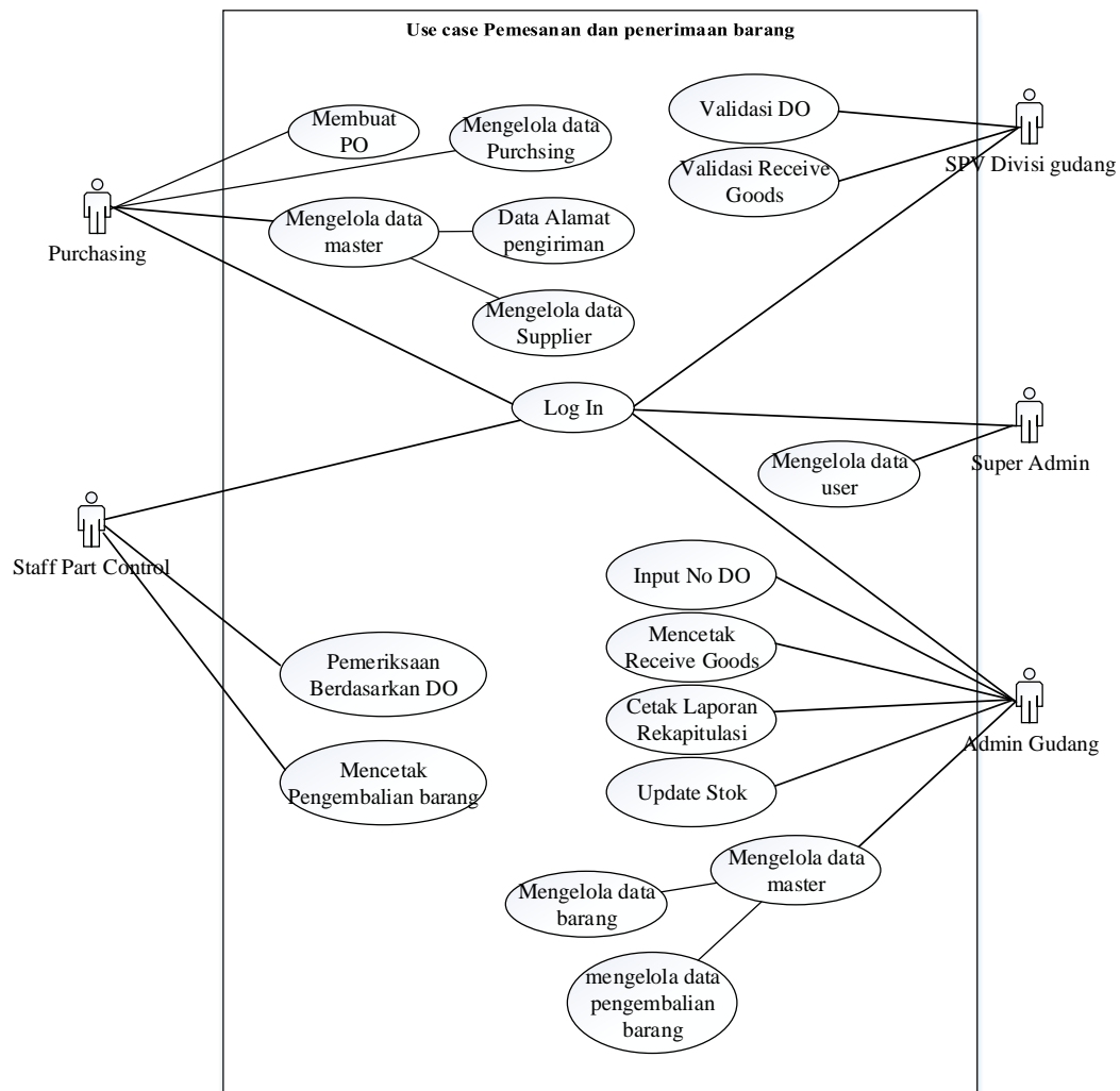
Gambar V.2 Use Case Diagram usulan sistem penerimaan barang Sumber: Hasil Analisis Data (2018)
