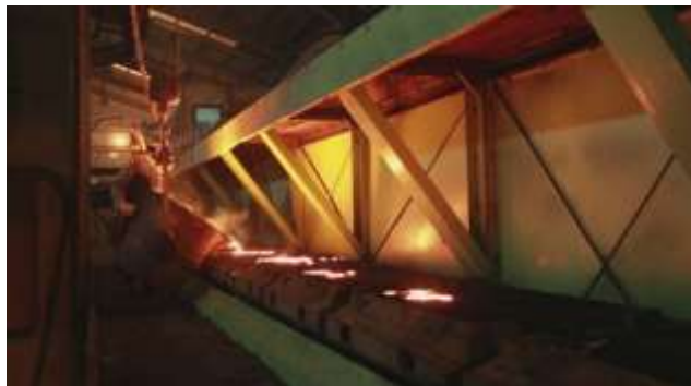
Gambar 4.19 Proses Pouring Sumber: PT Bakrie Autoparts
