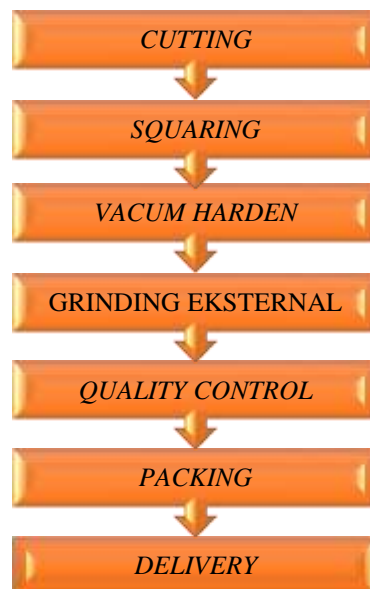
Gambar IV.4 Alur Proses Produksi Chuck Plate
