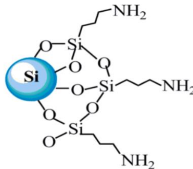
Gambar II. 9 Reaksi APTES dengan Silika (Sumber: Mousavi dan Fini, 2020)
