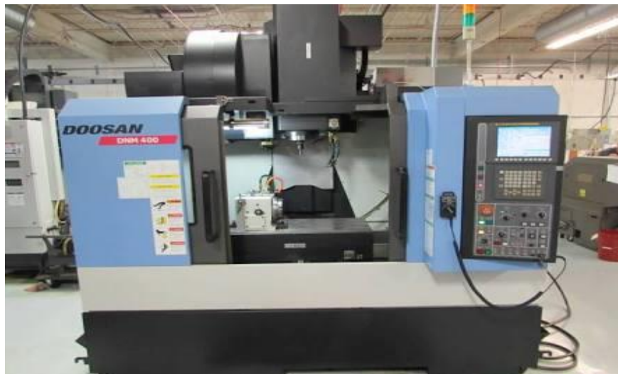
Gambar 4.24 Mesin CNC Doosan DNM 400 II
