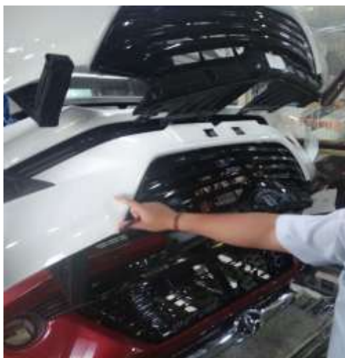
Gambar 4.5 Hasil Produksi Front Bumper yang sudah dilakukan pengecatan
