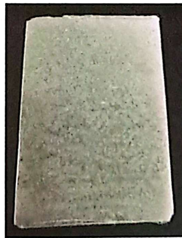
Pelat PLA/serat selulosa 10 %wt/triasetin 10 %wt
