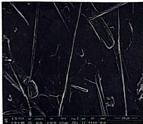
a. Serat selulosa sebelum proses ultrasonic homogenizer (perbesaran 120 kali)
