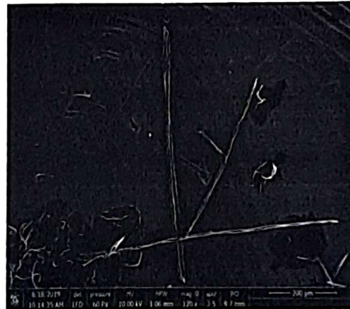
b. Serat selulosa sesudah proses ultrasonic homogenizer (perbesaran 120 kali)
