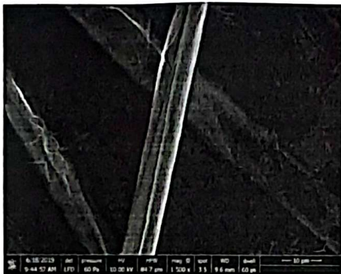
a. Serat selulosa sebelum proses ultrasonic homogenizer (perbesaran 1500 kali)
