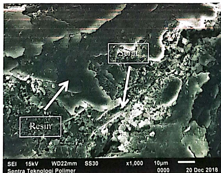
Gambar IV.3 Morfologi Permukaan Komposit Unsaturated Polyester /Eceng Gondok dengan Komposisi Eceng Gondok 30%
