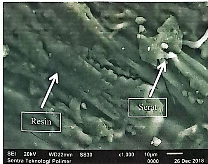
Gambar IV.5 Morfologi Permukaan Komposit Unsaturated Polyester /Inti Kenaf dengan Komposisi Inti Kenaf 30%
