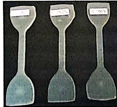
Spesimen uji tarik polipropilena pada 190°C
