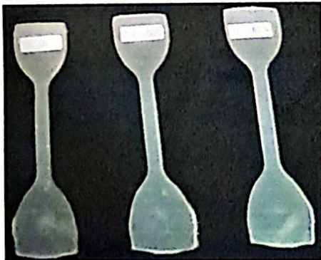
Spesimen uji tarik polipropilena pada 180°C
