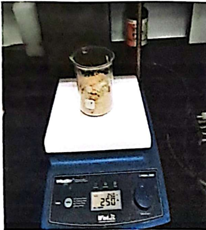
Proses Pencampuran Limbah Tapioka dengan Metil Metakrilat
