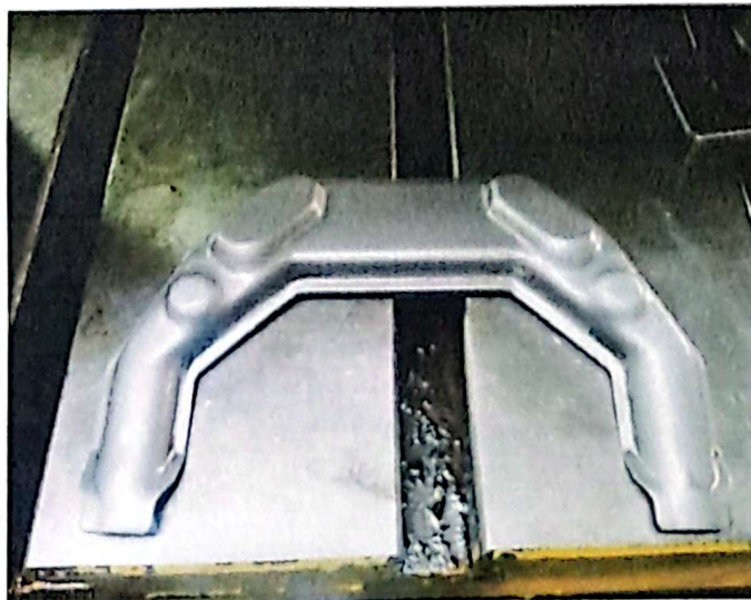
Gambar 4.10 Proses Trimming (Sumber: PT Nusa Indah Jaya Utama)
