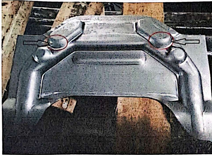
Gambar 4.14 Jenis Cacat Necking (Sumber: PT Nusa Indah Jaya Utama)
