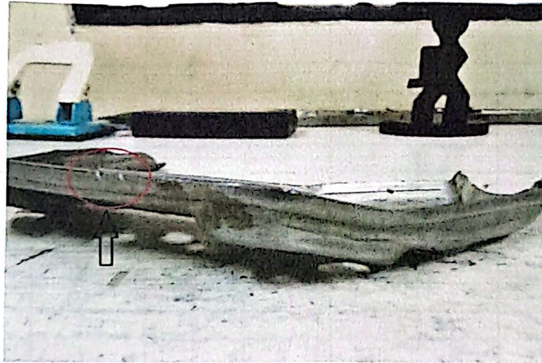
Gambar 4.16 Jenis Cacat Crack (Sumber: PT Nusa Indah Jaya Utama)
