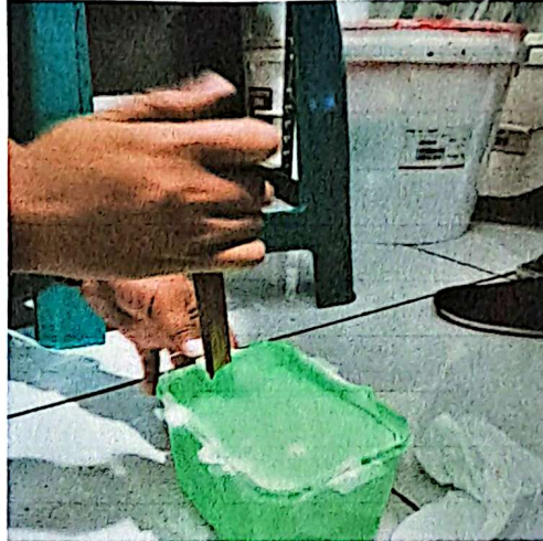
Gambar 4.18. Mixing Loctite LT 202 dengan Activator P2 (Sumber: PT Stahl Arbeit)
