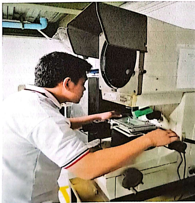
Gambar 4.16. Pengecekan Kualitas Dengan Mesin Profil Proyektor (Sumber: PT Stahl Arbeit)
