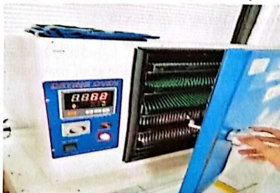
Gambar 4.22. Pemanasan Bolts M6X10 (Sumber: PT Stahl Arbeit)
