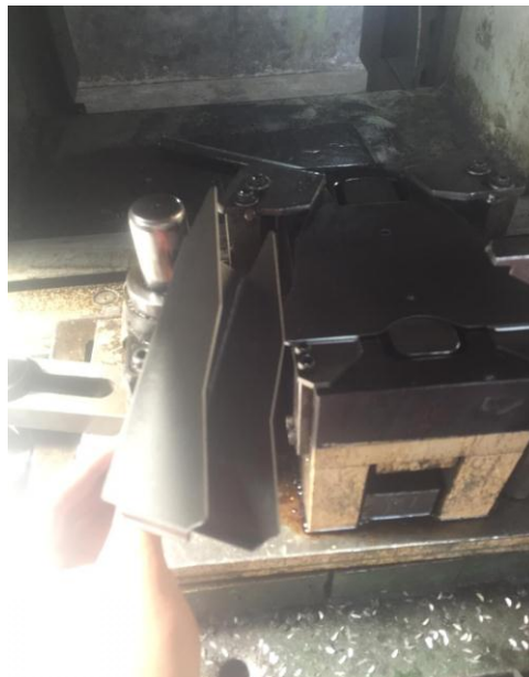
Gambar 4.9 Proses bending (Sumber: PT Nusa Indah Jaya Utama)
